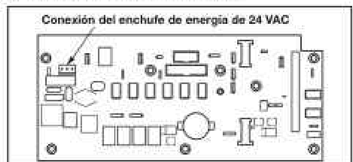
Figura 12. PCB del centro de energía (vista posterior)
