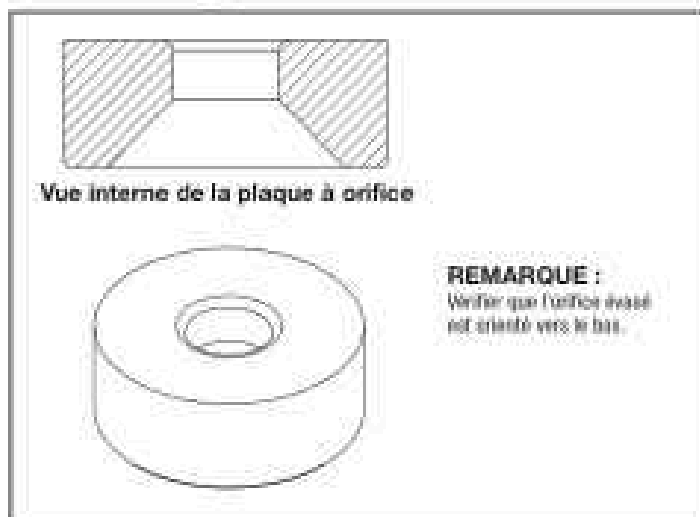
Figure 5. Bonne orientation de la plaque à orifice
