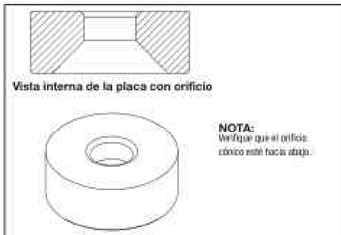
Figura 5. Orientación correcta de la placa con orificio
