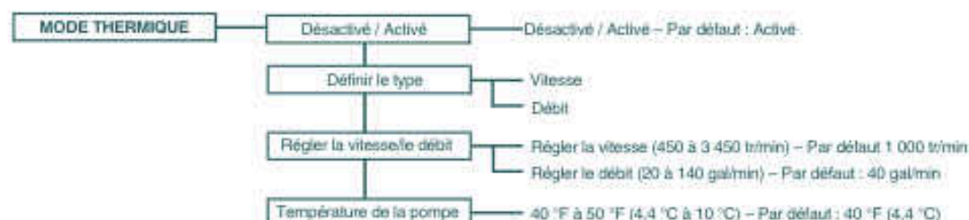
Réglage de la vitesse de la pompe en mode thermique
