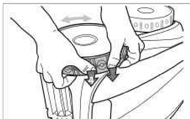
Figura 36. Empuje el neumático hasta ubicarlo en su posición
