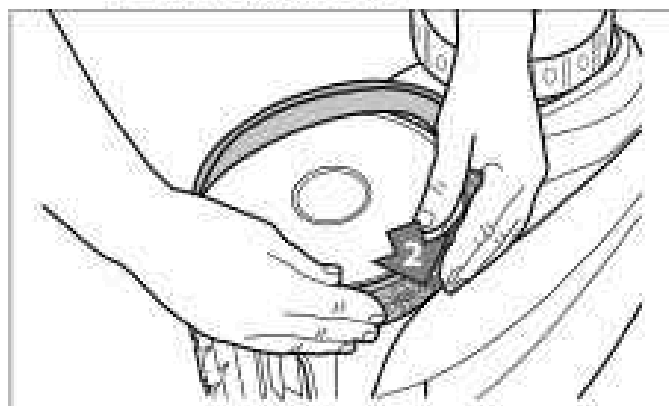
Figure 34. Commencer d'un côté du pneu
