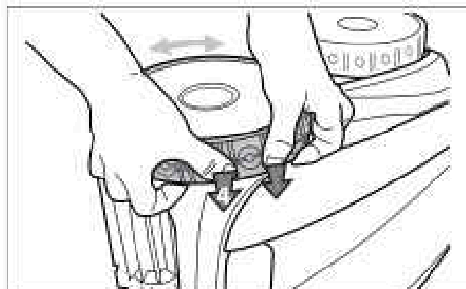
Figure 36. Poussez le pneu en place sur la roue
