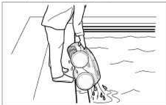
Figura 16. Sostenga el limpiador en posición vertical para drenar el agua
