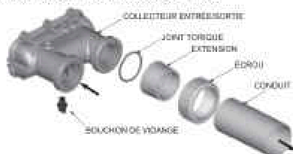
Figure 12. Installation du distributeur d'entrée/sortie de 2 po
